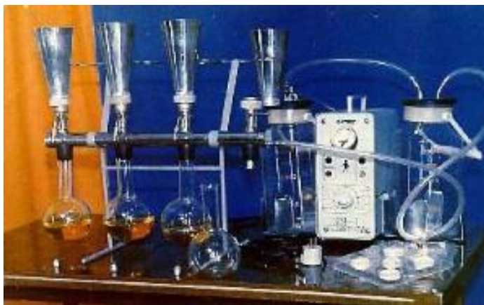
Şəkil 14. Membran vasitəsi ilə sterilizasiya aparılan qurğu
