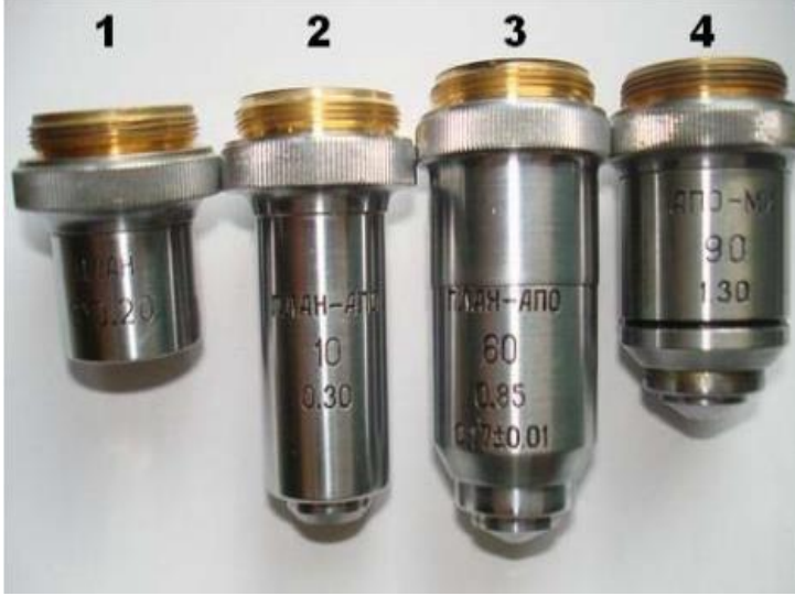
Şəkil 3. Mikroskopun obyektivləri: 1-planaxromat kiçik böyüdülmə üçün; 2 və 3 –planapoxromatlar; 4- immersion apoxromat
