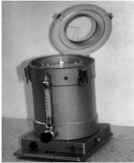
Şəkil 34. Krotov aparatı (havanın bakterioloji analizinin aparılması üçün)
